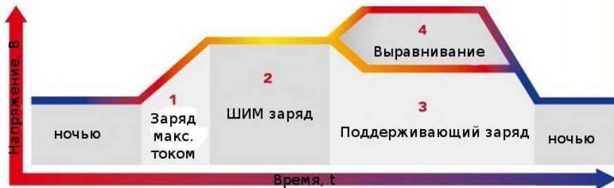
Рис.7. Стадии заряда аккумулятора
